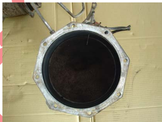
1 號廢氣溫度感測器及 DPF 前蜂巢結構
