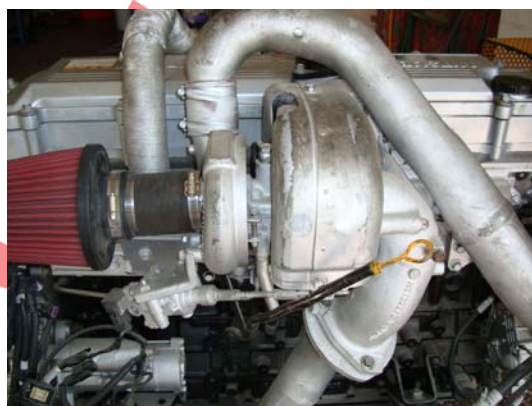
檢查進氣軟管及葉片間隙
