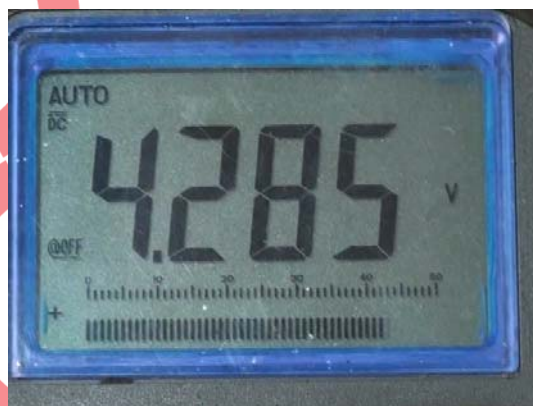
節氣門在閉合時為高電壓，打開時為低電壓
