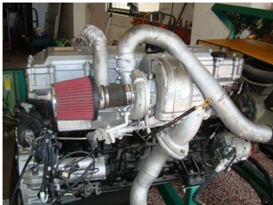
引擎排氣管側渦輪增壓器
