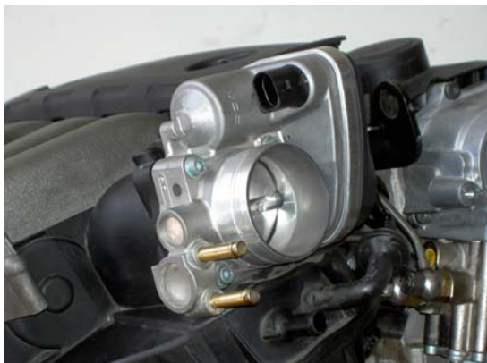
FSI 缸內直噴引擎 ETC—6 線式
