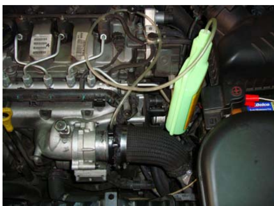
Ⓒ 加油至 2000rpm，調節中孔使藥劑進入量能配合轉速。
