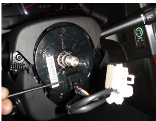
維修時需做記號，然後將安全氣囊感應線圈用紙質膠帶固定，以免損壞高昂零件
