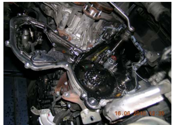
正時系統大修 (材料約 10 萬)
