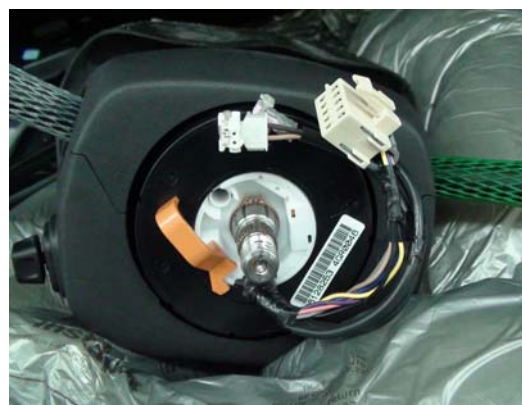
維修時需做記號，然後將安全氣囊感應線圈用紙質膠帶固定，以免損壞高昂零件
