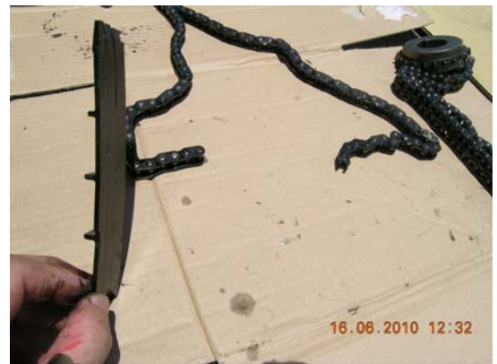
正時張力板磨損
