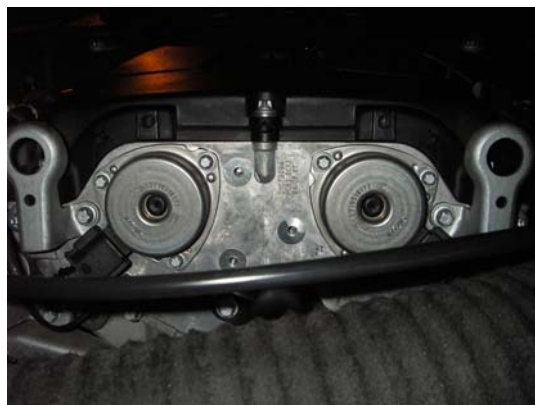
可變氣門正時控制電磁閥漏油
