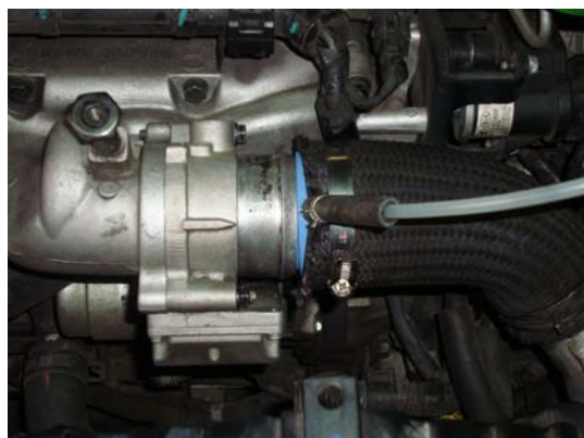
③ 束緊軟管，加油至 2000rpm
