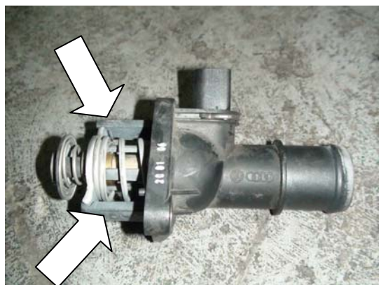
電子水龜（電子節溫器）塑膠固定腳座斷裂或加熱器故障
