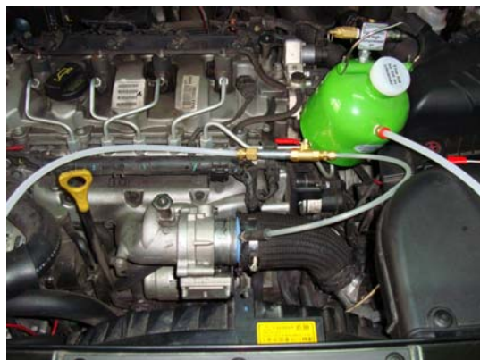
④ 加壓泡沫藥劑罐，調節進入量
