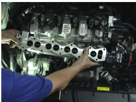
① 拆下進氣岐管清理積碳
